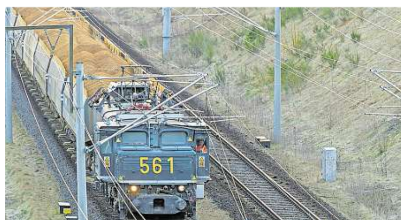
Weite Teile des Werksbahnnetzes sind elektrifiziert, die Spurweite ist mit der des öffentlichen Netzes identisch.
